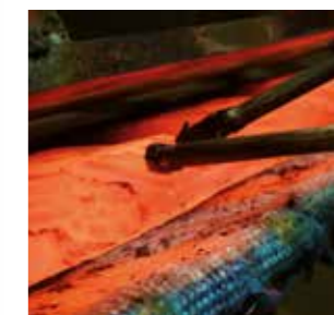
Löten als dauerhafte Verbindung von Hartmetall und Stahl
